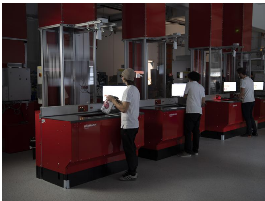
Abbildung 4: Mitarbeitende an den Kommissioniermodulen des Autostore Systems (Quelle: Hörmann Logistik, 2020)
